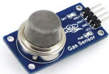
▲ Il sensore di gas MQ-5 può rilevare diversi gas nocivi nell'aria ed è molto sensibile
